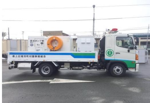
0.6MPa)各4本・発動発電機1台・操作制御盤1台・バルーン式投光器1灯・ポンプ付属品1式・車両付属品1式
